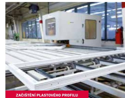
ZAČÍŠTĚNÍ PLASTOVÉHO PROFILU
